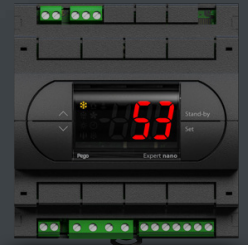
Ansteuerung für gepulste Expansionsventile
