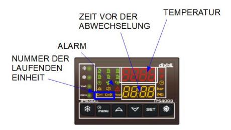
Im oberen Teil des Displays (rot) wird die gemessene Temperatur angezeigt. Der untere Teil des Displays (gelb) zeigt die Zeit bis zum nächsten Wechsel des Ausgangs an.
