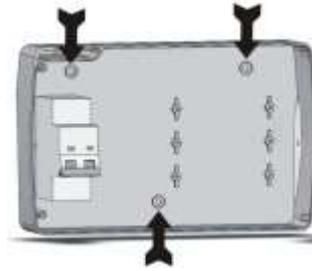
**Abb. 7:** Haken sie die Front wieder an den Gehäuseboden ein, indem Sie die Scharniere durch Biegen wieder in ihren Sitz einsetzen und kippen Sie alles um 180° nach unten, um an die Elektronikkarte zu gelangen.
