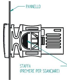
Die Tafleinbau-Geräte XR60C sind für einen Ausschnitt 71x29 mm vorgesehen und werden mit zwei Befestigungsbügel fixiert. Die Befestigungsbügel von hinten aufschieben und durchschieben bis beide Bügel fest einrasten.
