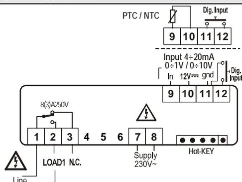
Fühler: Pt100=9 -11 (10); Thermoelement J, K, S = 9(+); 11(-), 230VAC Hilfsenergie: 7-8
