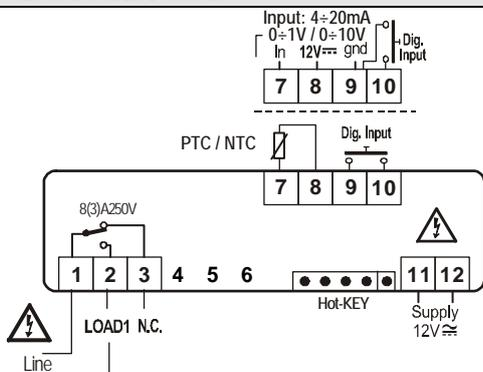
Fühler: Pt100= 7 - 9 (8); Thermoelement J, K, S = 7(+); 9(-), 12VAC/dc od. 24VAC/cd Hilfsenergie: 11-12
