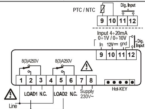
Fühler: Pt100=9 –11 (10); Thermoele. J, K, S = 9(+)- 11(-), 230VAc Hilfsenergie: 7-8
