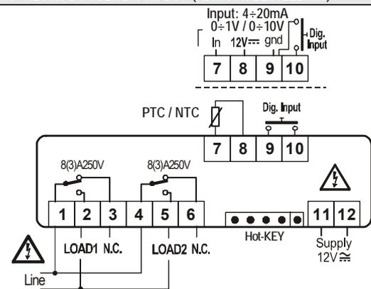
Fühler: Pt100=7 – 9 (8); Thermoele. J, K, S = 7(+); 9(-), 12VAc/dc od. 24VAc/dc Hilfsenergie: 11-12
