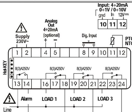
Fühler: Pt100= 10 – 12 ; Thermoele. J, K, S = 11(+);12(-), HOT-KEY Anschluß auch für XJ485 + CAB/RS1 (Dixell-Aufzeichnungssysteme)
