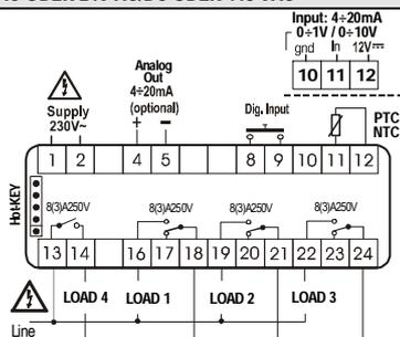
Fühler: Pt100= 10 – 12 ; Thermoele. J, K, S = 9(+)- 11(-), HOT-KEY Anschluß auch für XJ485 + CAB/RS1 (Dixell-Aufzeichnungssysteme)
