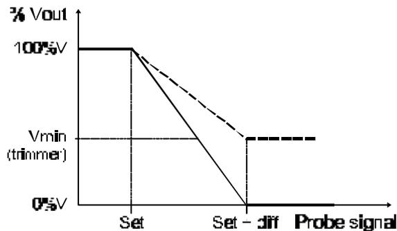
Wenn das Eingangssignal den Sollwert Set unterschreitet ist das Ausgangssignal 230 V (Gebläse mit max. Geschwindigkeit). Wenn das Eingangssignal sich vergrößert und den Bereich zwischen Set und Set+Diff erreicht proportionale Regelung. Oberhalb von Set+diff ist die Spannung immer 0 V (falls nicht eine Mindestgeschwindigkeit Vmin vorgegeben wurde).
