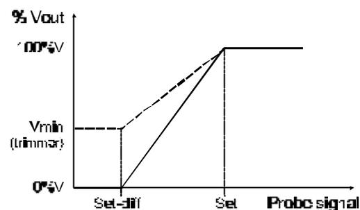
Wenn das Eingangssignal höher als der Sollwert Set ist, ist das Ausgangssignal 230 V (max. Geschwindigkeit der Gebläse). Wenn der Pegel sinkt und den Bereich zwischen Sollwert Set und Set-Diff erreicht proportionale Regelung. Unterhalb von Set-diff ist der Ausgang immer 0 V (falls keine Mindestgeschwindigkeit Vmin vorgegeben wurde).
