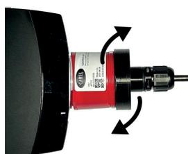
Schrauben Sie den markierten Teil des Kalibrierungsbausatzes auf den Sensor des zu kalibrierenden Gerätes.
