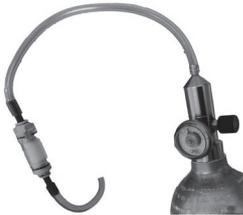
Montieren Sie die verschiedenen Komponenten, wie in der Abbildung gezeigt, mit Ausnahme der Schlauchverbindung zum GLD.
