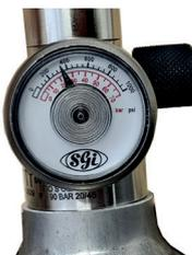
Öffnen Sie den Regler an der Gasflasche mit einem Druck von ca. 0,5 l/min. Lassen Sie das Gas einige Sekunden lang strömen, ohne dass der Kalibrierungsadapter an den Sensor angeschlossen ist. Schließen Sie dann den Schlauch an den GLD an.
