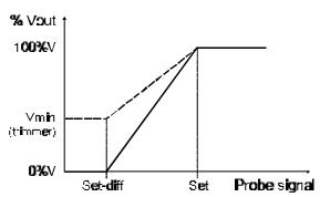
Wenn das Eingangssignal höher als der Sollwert Set ist, ist das Ausgangssignal 230 V (max. Geschwindigkeit der Gebläse). Wenn der Pegel sinkt und den Bereich zwischen Sollwert Set und Set-Diff erreicht proportionale Regelung. Unterhalb von Set-diff ist der Ausgang immer 0 V (falls keine Mindestgeschwindigkeit Vmin vorgegeben wurde).
