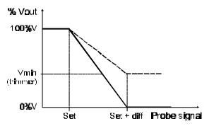
Wenn das Eingangssignal den Sollwert Set unterschreitet ist das Ausgangssignal 230 V (Gebläse mit max. Geschwindigkeit). Wenn das Eingangssignal sich vergrößert und den Bereich zwischen Set und Set+Diff erreicht proportionale Regelung. Oberhalb von Set+diff ist die Spannung immer 0 V (falls nicht eine Mindestgeschwindigkeit Vmin vorgegeben wurde).
